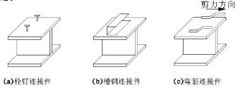
图 11.3.1 连接件的外形及设置方向
